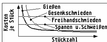
Bild 5: Grenzstückzahlen für verschiedene Fertigungsverfahren (schematisch).
